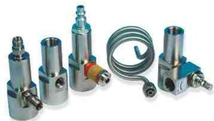
DMT242SC2, DMT242SC和DSC74的采样室(左起)可以直接用来将DM70与样气流连接。DSC74B(右)是一种双压力采样室，可用于带压或常压测量。DSC74C采样室含有冷却/泄露螺旋，但是属于选配范围。
