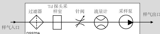
DSS70A采样系统的过滤器可清除样气杂质，针阀则利用流量计对样气流速进行控制。采样泵在环境压力下从生产过程中生成样气气流。
