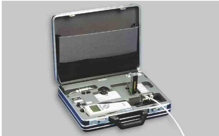
DSS70A可在直接测量困难的情况下在狭小的空间进行现场露点测量。采样系统一般可应用于金属处理和塑料干燥处理。
