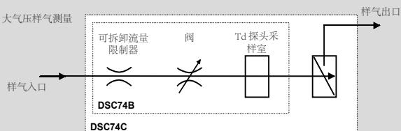
DSC74B采样室可以根据样气输入和输出的不同情况在最高10 bar的带压气体或常压下对样气进行测量。DSC74C与DSC74B类似，但是配备了一个辅助螺旋以避免反向扩散以及周围水分对常压露点测量的影响。
